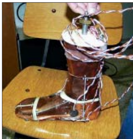
Slika 1. Toplotno stopalo. Na levi sliki so razvidni ogrevani bakreni segmenti. Za ovrednotenje delovanja toplotne noge smo na šestih segmentih izračunali toplotno izolacijo s pomočjo neodvisne metode, tako da smo merili razliko v temperaturi med površino stopala in vode ter toplotni tok na površini segmenta (dva merilka toplotnega toka sta razvidna; eden na nartu, drugi na notranjem delu stopala). Na desni sliki je prikazano toplotno stopalo obuto v testnem pohodnem čevlju.
