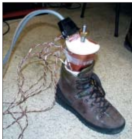
Slika 1. Toplotno stopalo. Na levi sliki so razvidni ogrevani bakreni segmenti. Za ovrednotenje delovanja toplotne noge smo na šestih segmentih izračunali toplotno izolacijo s pomočjo neodvisne metode, tako da smo merili razliko v temperaturi med površino stopala in vode ter toplotni tok na površini segmenta (dva merilka toplotnega toka sta razvidna; eden na nartu, drugi na notranjem delu stopala). Na desni sliki je prikazano toplotno stopalo obuto v testnem pohodnem čevlju.
