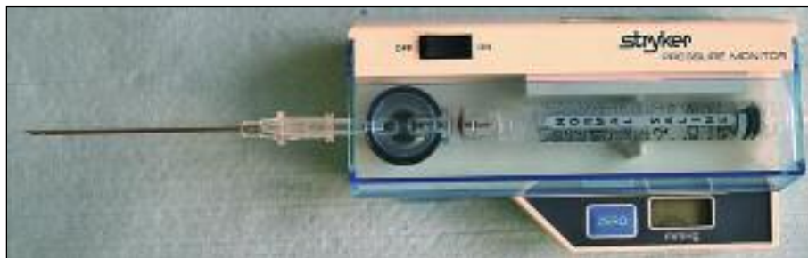
Slika 9. Naprava za merjenje tlaka znotraj kompartmentov.
